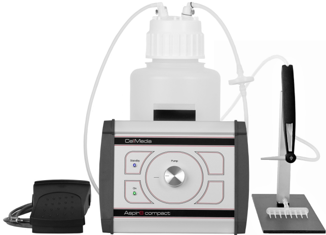
Ansicht des Gerätes von vorn (der Fußschalter ist anstelle des Tasters optional lieferbar)
