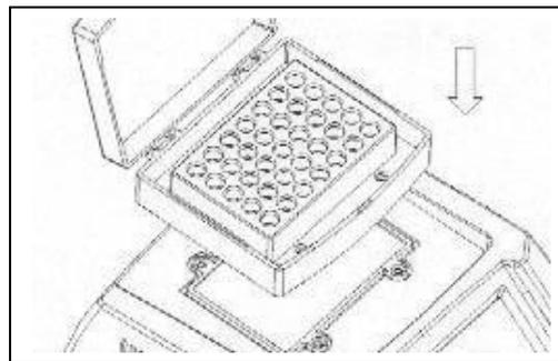
Setzen Sie bitte wieder die vier Befestigungsschrauben in die dafür vorgesehenen Löcher ein und ziehen zuerst zwei Schrauben in der Diagonalen mit einem Inbusschlüssel vorsichtig fest. Dann die zwei anderen Schrauben festziehen. Die Schrauben nur so fest anschrauben, dass sie auch ohne großen Kraftaufwand wieder gelöst werden können.
