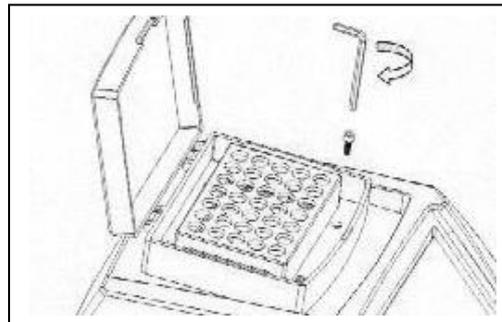
Bitte achten Sie darauf, dass beim Einsatz des Blockes J für Mikroplatten die mitgelieferten 4 Distanzscheiben auf die Inbusschrauben zwischen dem Block und der Temperaturplatte gesetzt werden. Ist das nicht der Fall, kann sich der Block beim Festziehen verwinden und der Deckel lässt sich nicht bzw. schlecht schließen! Dieser Hinweis gilt ausschließlich für Block J!
