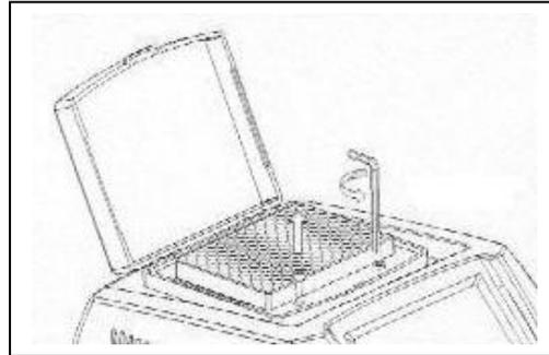
Entfernen Sie die Schrauben, schließen Sie bitte den Deckel und nehmen Sie den Wechselblock komplett ab.
