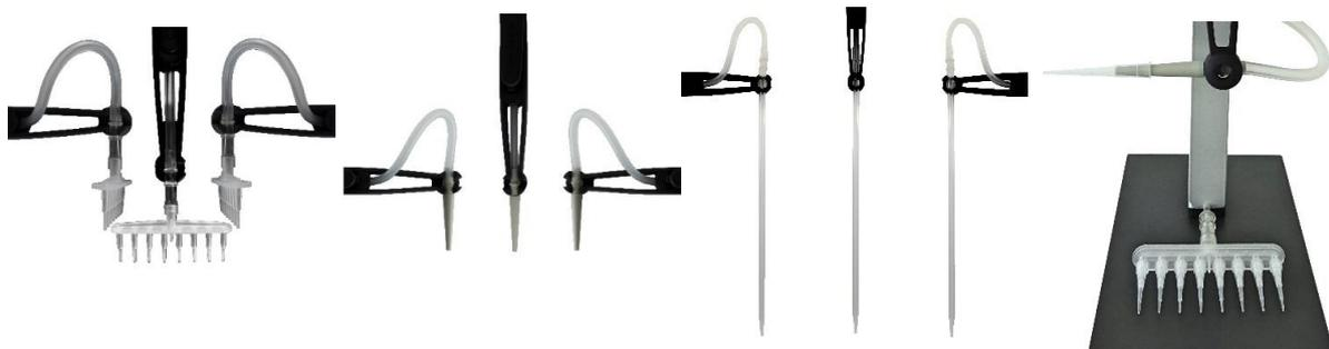
Darstellungen: 8-Kanal-Verteiler mit Adapter, Absaugspitze, serologische Pipette mit Adapter, sowie beim letzten Bild mit Pipettenspitzen als Verlängerung an Absaugspitze und 8-Kanal-Verteiler.
